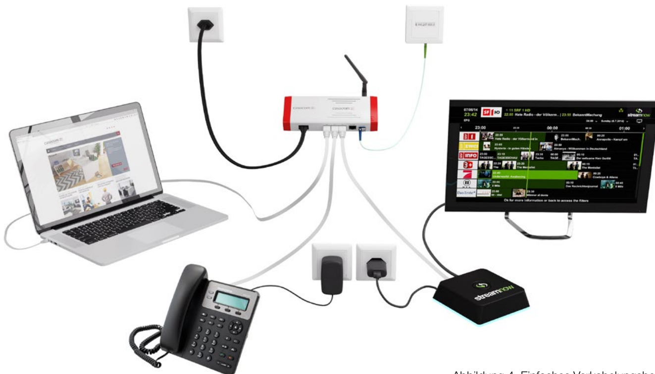
Abbildung 4: Einfaches Verkabelungsbeispiel
